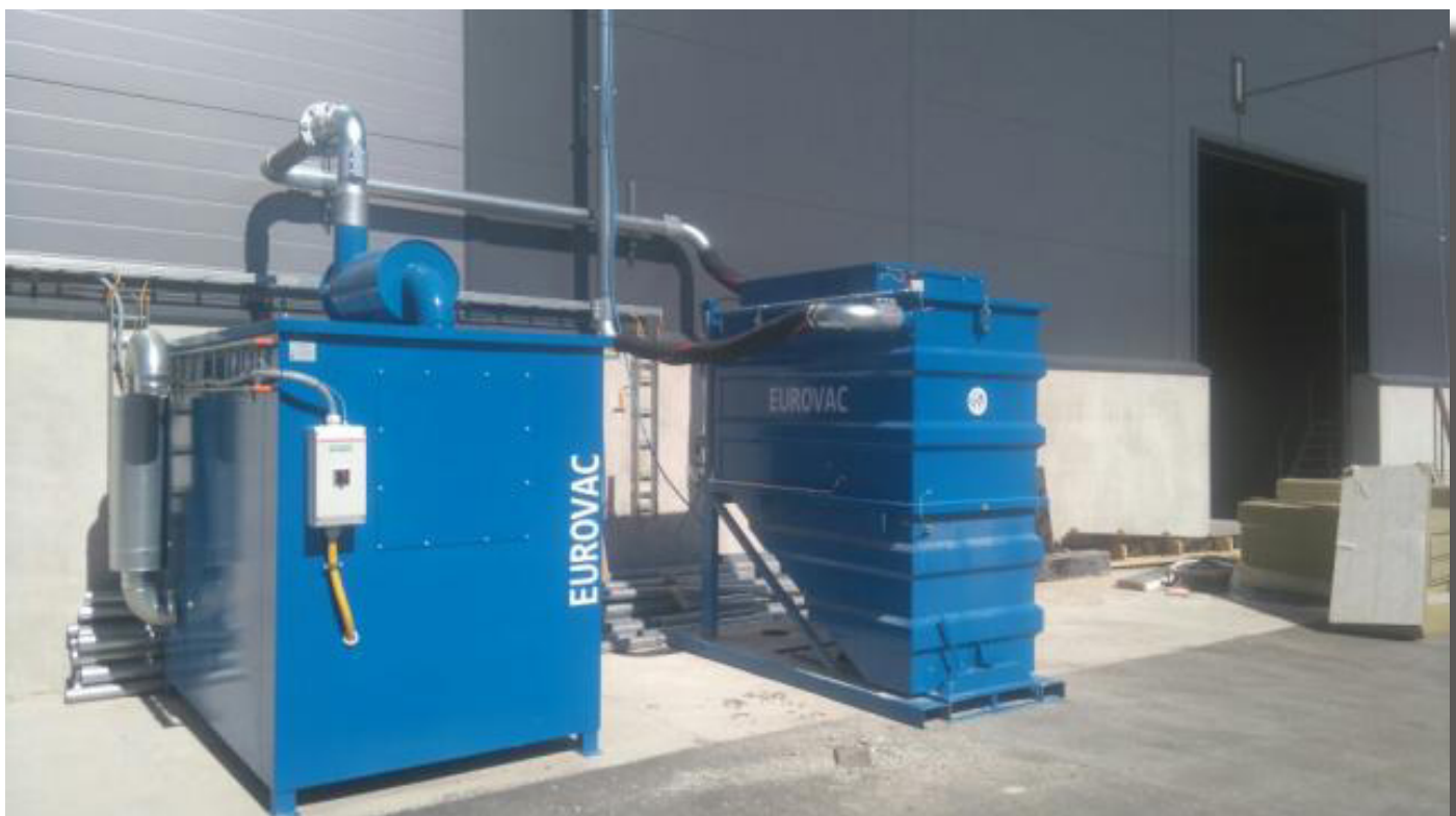
Eurovac 45 kW kiertomäntäimuyksikkö + kipperisuodatinyksikkö
