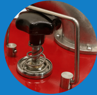
Suodattimen puhdistus ravistintangolla
