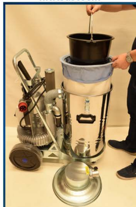
Lihtsasti hooldatav ja mitmekihiline filtrisüsteem
