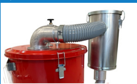
Filtri käsitsi puhastamine raputusmehhanismi abil
