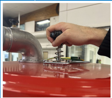
Filtri käsitsi puhastamine raputusmehhanismi abil
