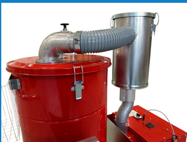
Lisävaruste: Saatavilla HEPA13-suodatin. Kuvassa kotelo, joka sisältää HEPA13-suodattimen – se parantaa poistoilman puhtautta ja soveltuu erityisesti ongelmallisen hienopölyn suodatukseen.
