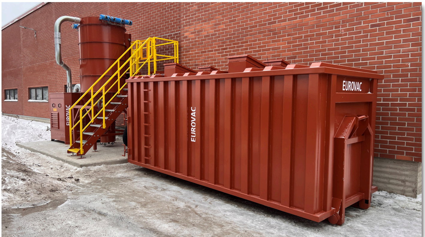
Eurovac imuyksikkö 55kW kiertomäntäpuhaltimella + 1400/32 suodatinyksikkö + esierotinkontti 20 m 3
