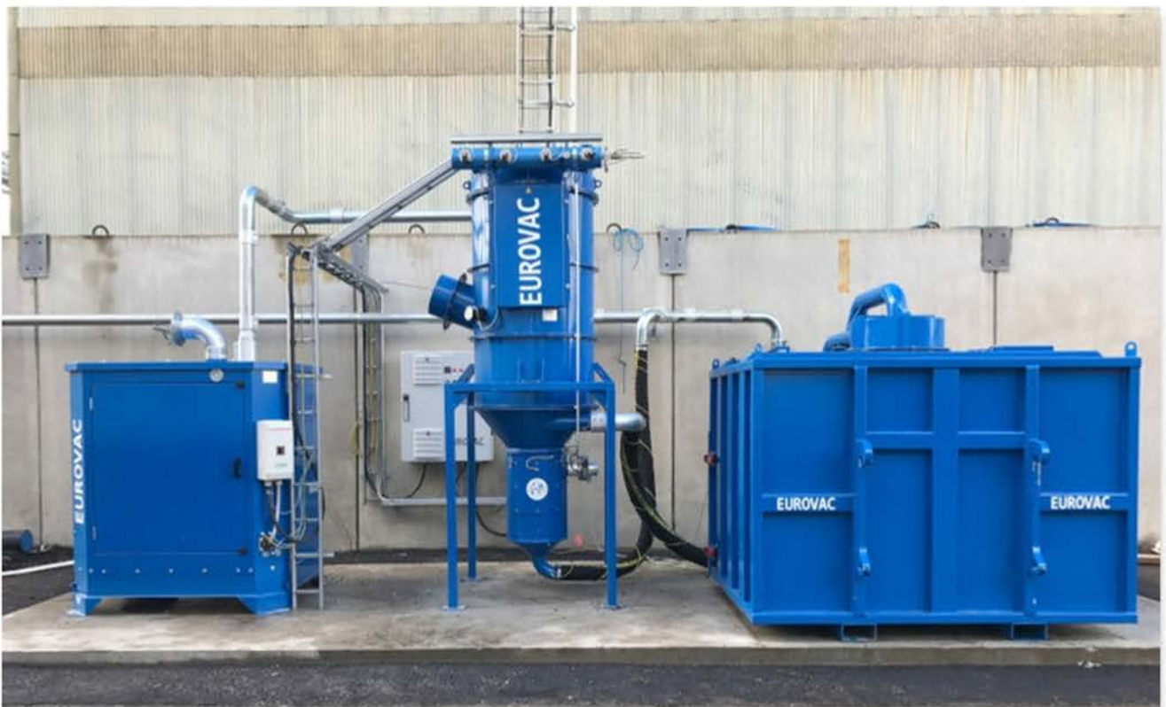
Eurovac 900 -suodatinyksikkö, 5 m 3 esierottimella ja 37 kW kiertomäntäyksiköllä
