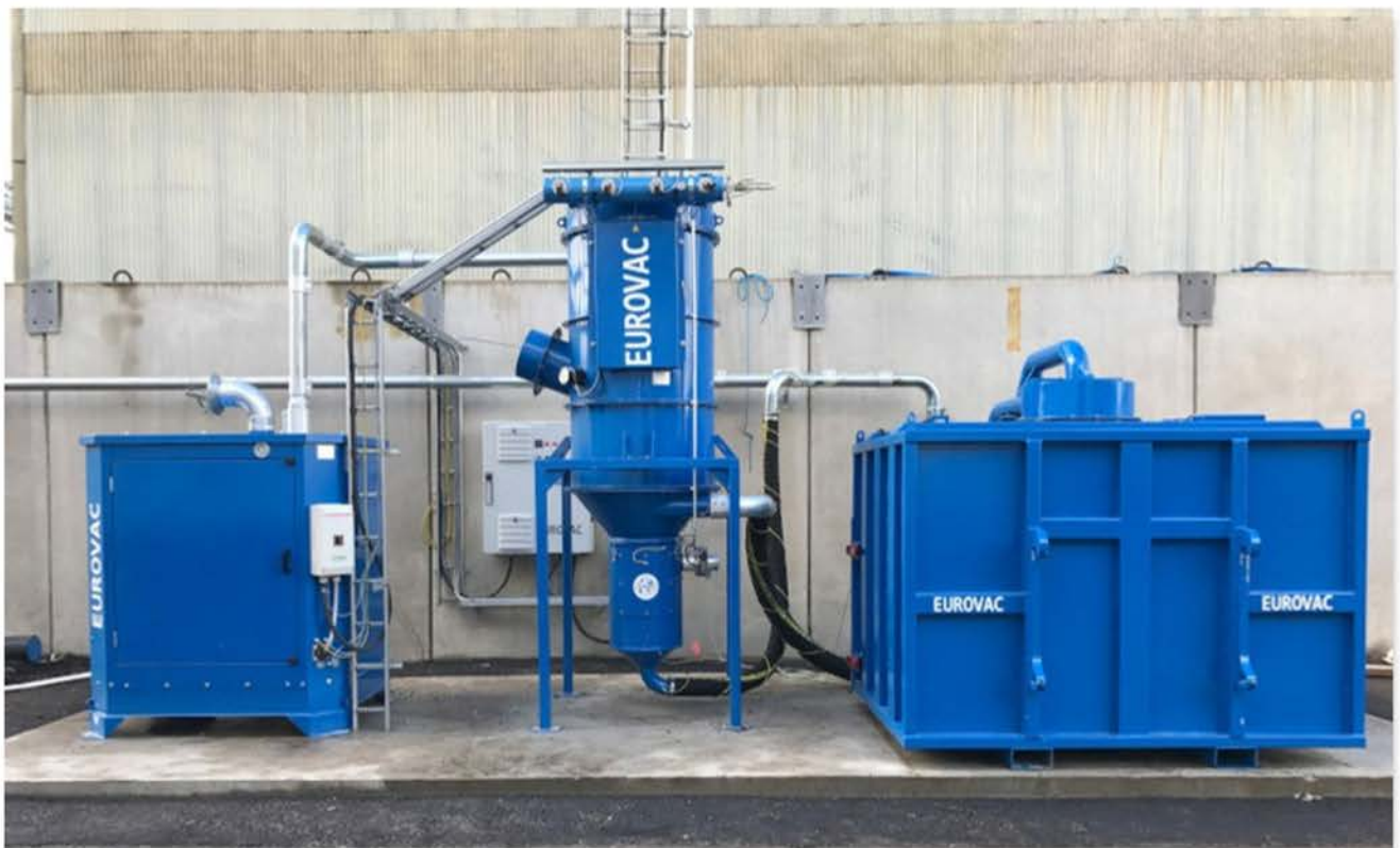
Eurovac 900 Filteranlage, 5 m 3 mit Vorabscheider und 37 kW Drehkolbenkompressor
