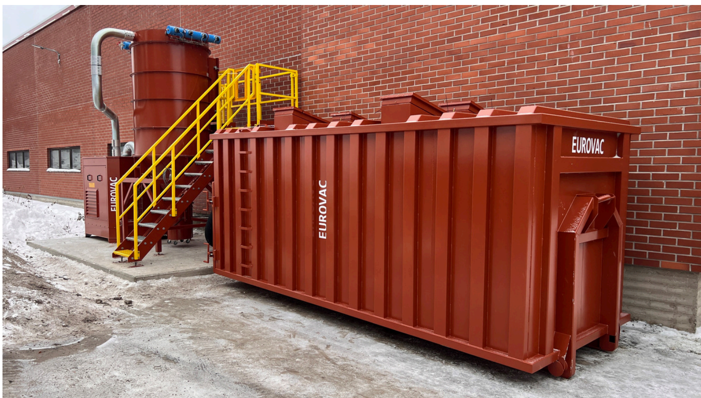
Eurovac imuyksikkö 55kW kiertomäntäpuhaltimella + 1400/32 suodatinyksikkö + esierotinkontti 20 m 3
