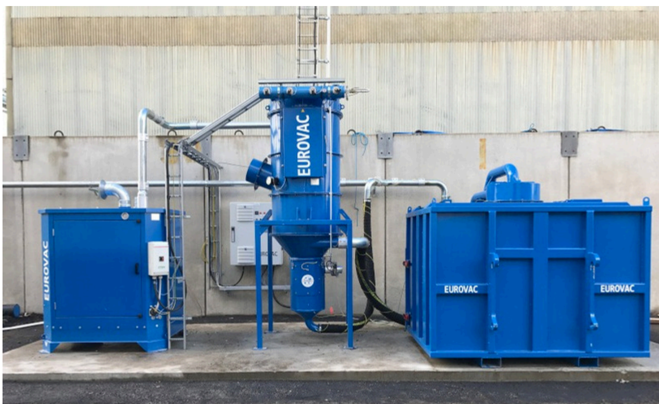
Eurovac 900 - jednostka ssąca 5 m 3 z separatorem wstępnym i rotacyjną jednostką tłokową 37 kW
