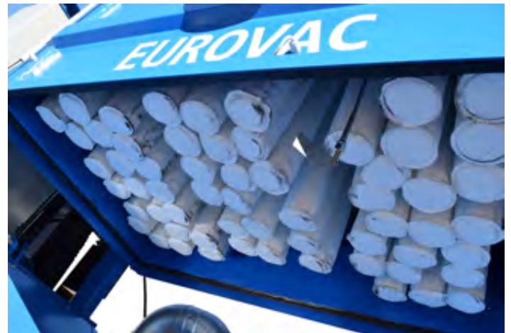
Laite on varustettu letkusuodattimilla 63 kpl joiden yhteispinta-ala yht. 20m 2
