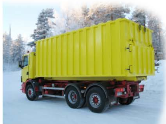
Kontener separatora wstępnego z adapterem na kontener wymienny (20 m 3 )
